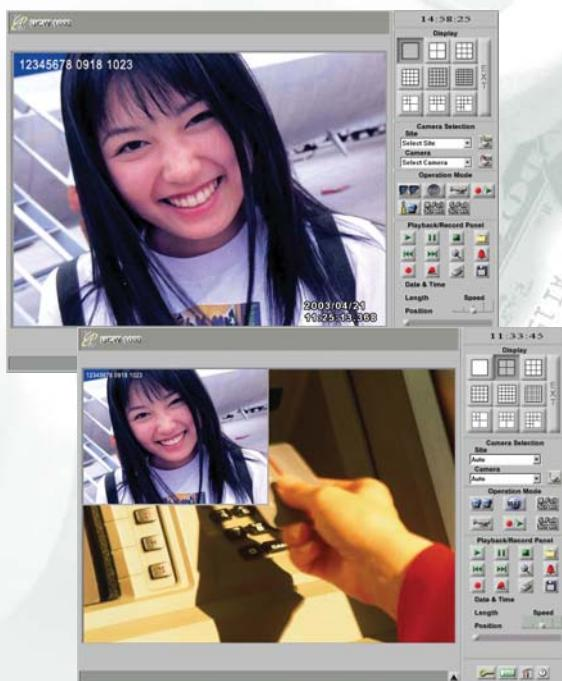
由于对日期的敏感性，系统记录的一串字符连同日期时间精确到百分之一秒。在安装这套软件时，可调整这串字符在屏幕上显示的位置，这样可增加用户的选择以适应他们的要求。
