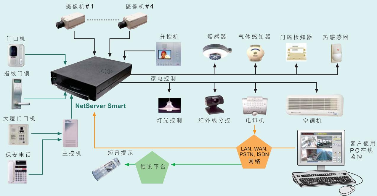
本系统以 NetServer Smart 为基础(见图9)，系统非常小巧，并有一组输出端口可与所有输入/出端口连接，任何标准器材如安防对讲机可以通过接入界面组成一个完整的解决方案。
