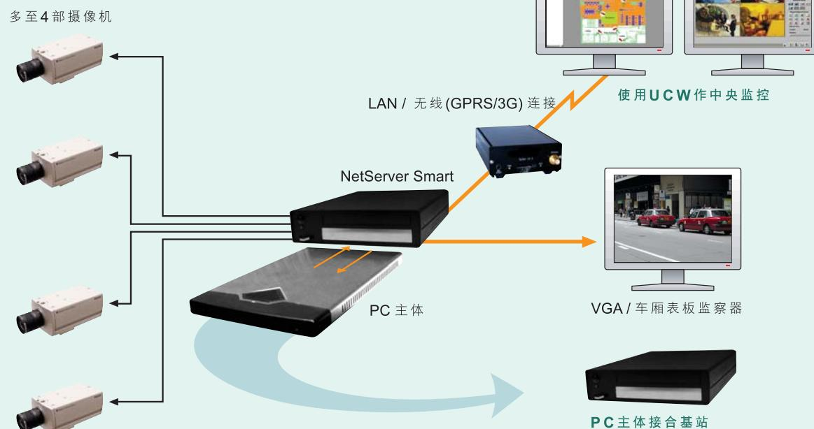
图 14 展示 **NetServer Smart** 使用可移动组件通过 GPRS/3G 调码器作无线监控方案。视频可通过 GPRS/3G 即时传送到控制中心，或是在脱线方式通过 PC 主体接合基站进行镜像备份。
